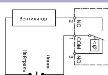
Вентилятор системы осушения воздуха
